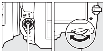
Tlačítko režimů automatického zaostřování
