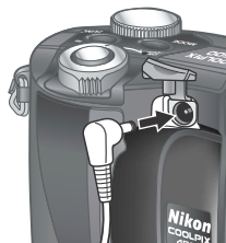
Zapojení síťového zdroje do konektoru DC-IN fotoaparátu COOLPIX4500.
