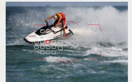
Dynamic-area AF mode using 21 points
