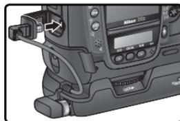
5 Passez le câble derrière la glissière située sur le volet du logement pour accumulateur BL-2.
